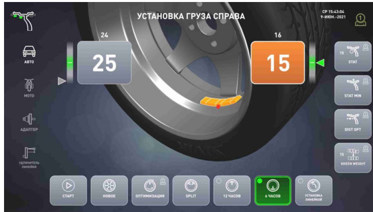
б – установка груза в «6 час»
