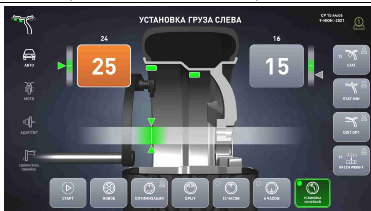
Рисунок 5.10 – Экран при установке груза линейкой
